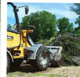
1. LA MACHINE AMPHIBIE, équipée de fourches, se fraie un chemin dans le plan d'eau envahi par la jussée afin d'arracher le système racinaire de la plante.
